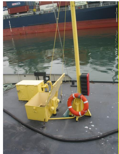
Figura 6: Meio de recolha de resíduos oleosos a navios no porto de Leixões.
